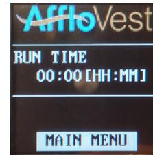
Figura 4. Menú Usage (Uso) con información del tiempo de funcionamiento
